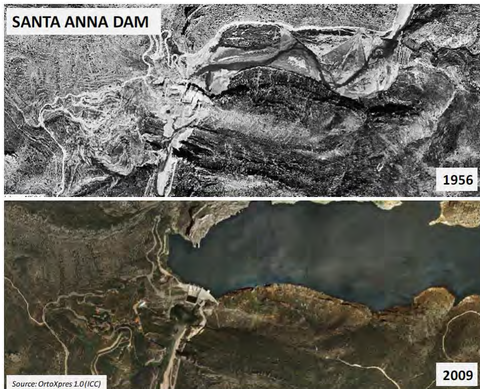
FIGURA 28. Cambios experimentados por la Noguera Ribagorçana aguas abajo de la presa de Santa Ana desde la década de 1960 hasta 2009. Autor: Ramon Batalla y Damia Vericat.
