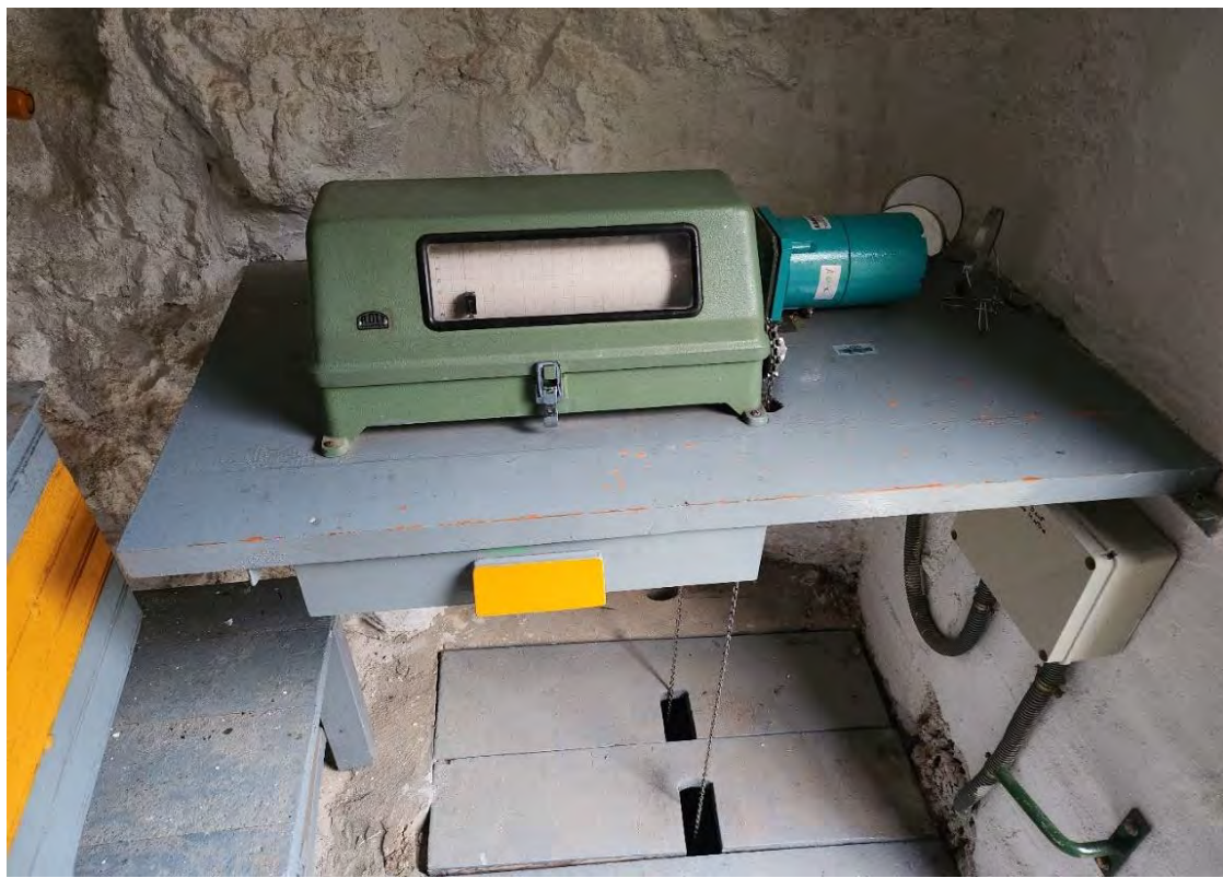
FIGURA 12. Limnógrafo instalado en la EA A097 que genera el limnigrama.
