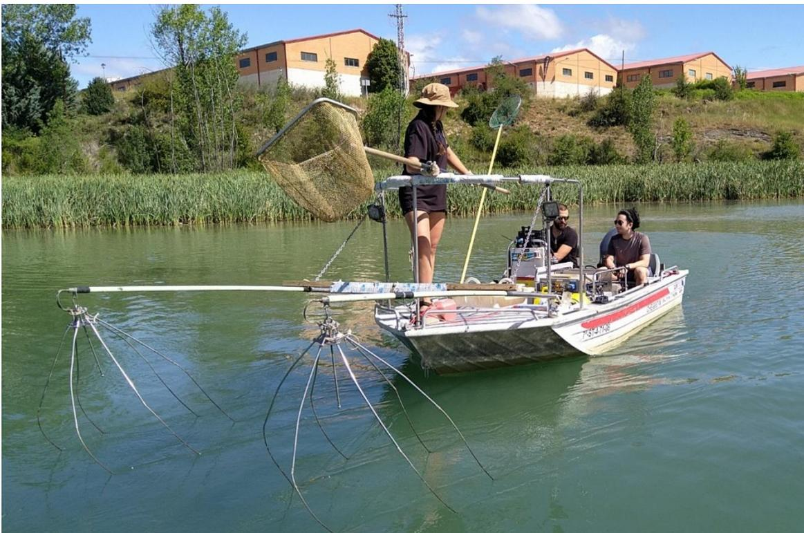
**Figura 7.** Equipo de electropesca desde embarcación en el embalse de Sabiñánigo
