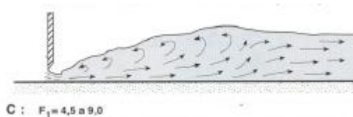
Figura 34. Apariencia del resalto hidráulico en canal de descarga
