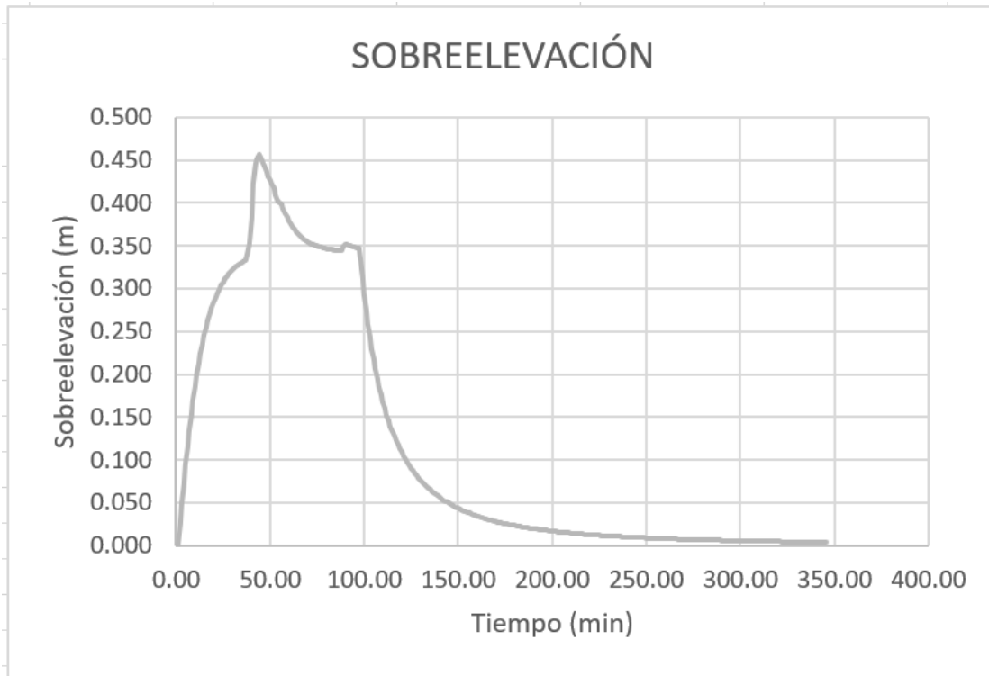
Figura 19. Sobreelevación con radio de vertido 3 m
