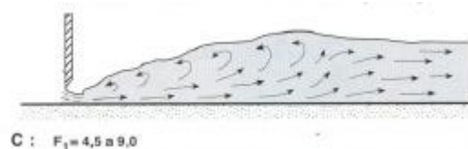
Figura 40. Apariencia del resalto hidráulico en canal de descarga para el caudal máximo del desagüe de fondo
