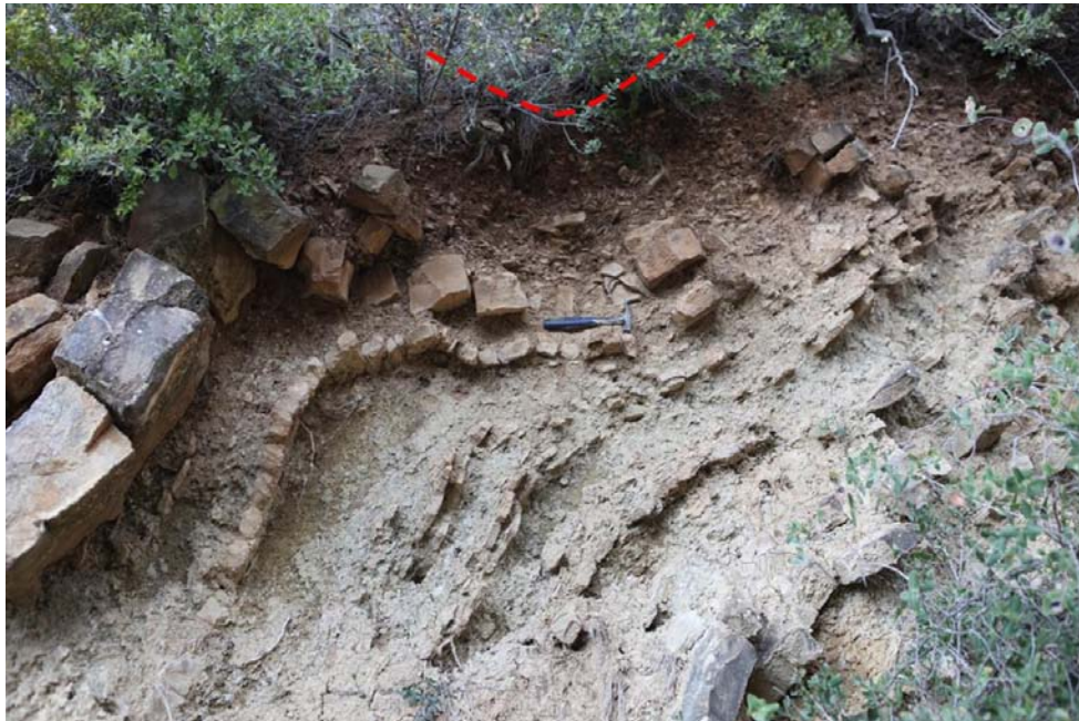
Figura 17. Capas de arenisca buzando hacia el sur con fracturas dilatadas y rellenas de material arcilloso (punto 22).
