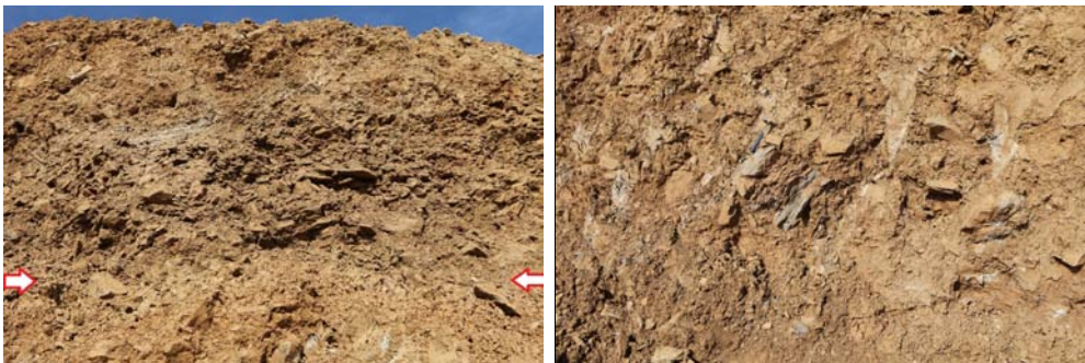
Figura 13. Punto de observación 11. A la izquierda, detalle de la unidad coluvial superior. Las flechas indican la posición aproximada de la base. A la derecha, detalle de la brecha de flysch correspondiente al depósito de deslizamiento.
