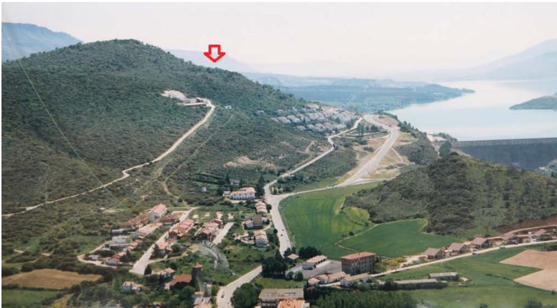
Figura 6. Vista aérea de la ladera en la que se reconoce el amplio rellano correspondiente a la parte superior del deslizamiento antiguo (flecha roja).
