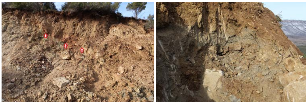
Figura 15. Vaguada correspondiente al límite este del deslizamiento en el punto 14. Se reconoce un relleno canaliforme sobre un paleosuelo desarrollado sobre una paleotopografía en surco (flechas rojas). Al oeste del surco el flysch está brechificado (abajo a la izquierda), mientras que al este se encuentra in situ (abajo a la derecha).
