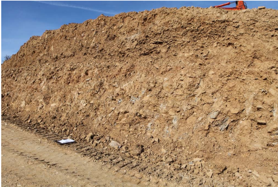
Figura 12. Excavación realizada bajo el rellano superior en torno al punto 11, en la que se diferencia un flysch brechificado por deslizamiento con fábrica aparentemente caótica y una unidad coluvial superior en la que los clastos presentan una disposición subparalela a la superficie topográfica.
