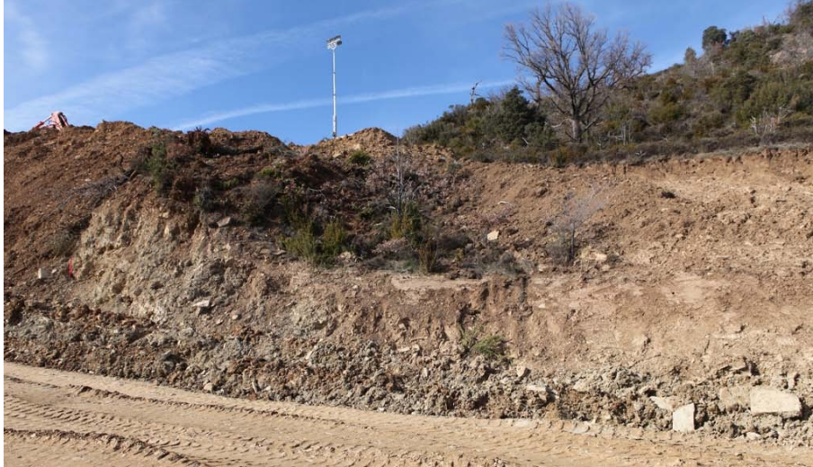
Figura 14. Vaguada longitudinal atribuida a límite este del deslizamiento. Al oeste de la misma (izquierda), flysch brechificado.
