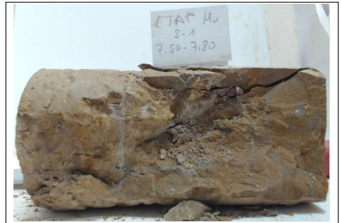
Detalle del plano de rotura
