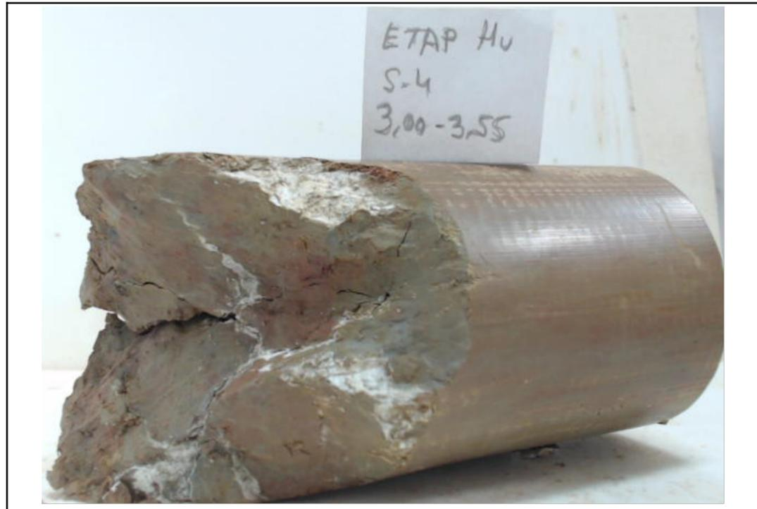
Detalle del plano de rotura
