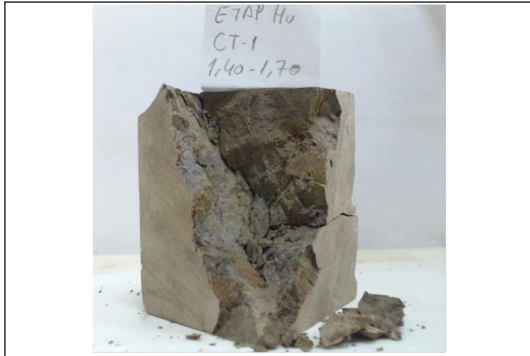
Detalle del plano de rotura
