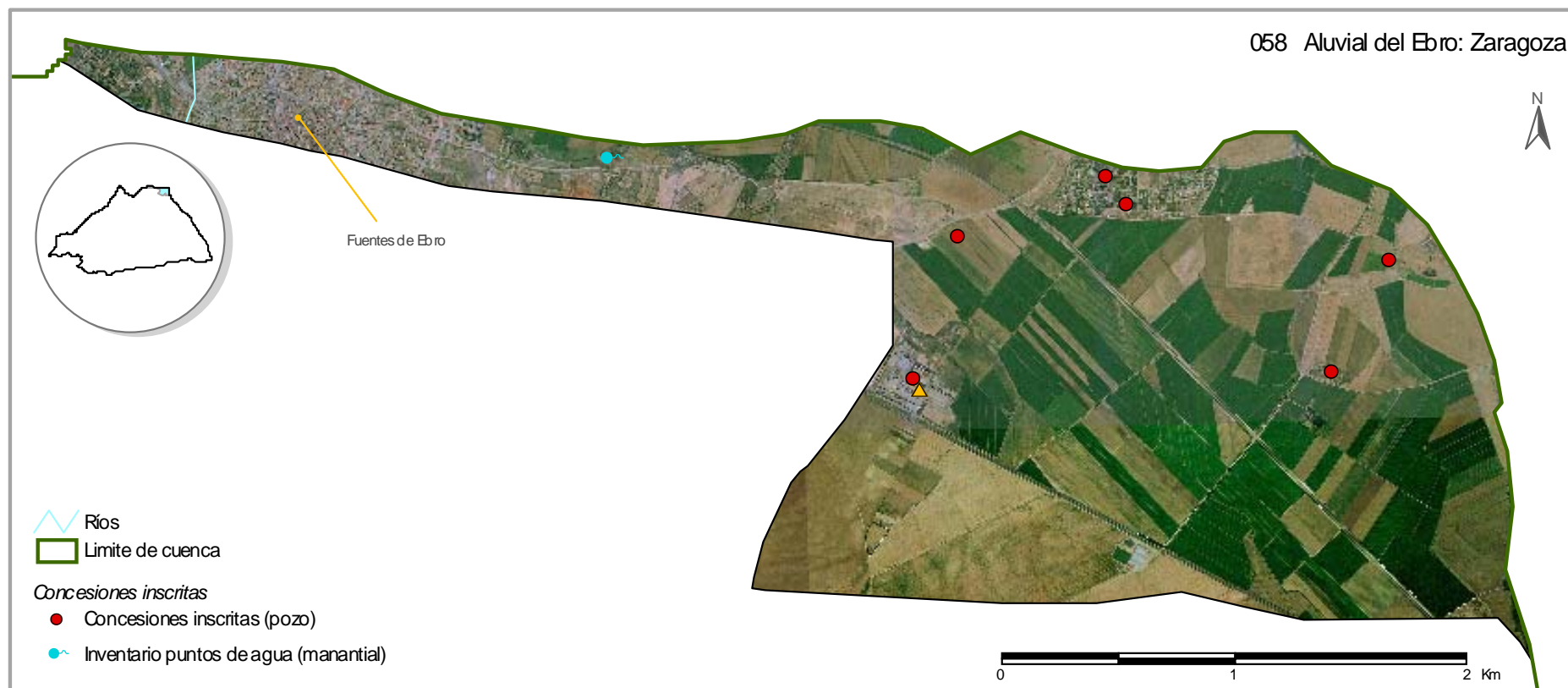
Figura 3.8: Principales presiones a las que esta sometida la masa de agua subterránea del aluvial del Ebro: Zaragoza.
