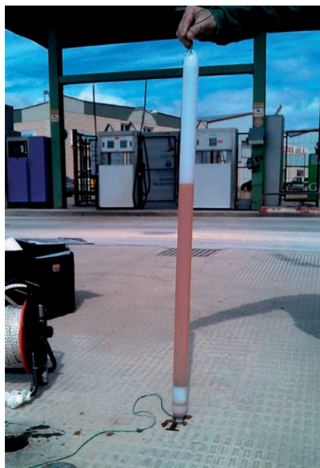
■ FIGURA 5.3.32 FASE LIBRE DE HIDROCARBURO EN EL PIEZÓMETRO 251050088 (09/04/2013). ZONA 049-03
