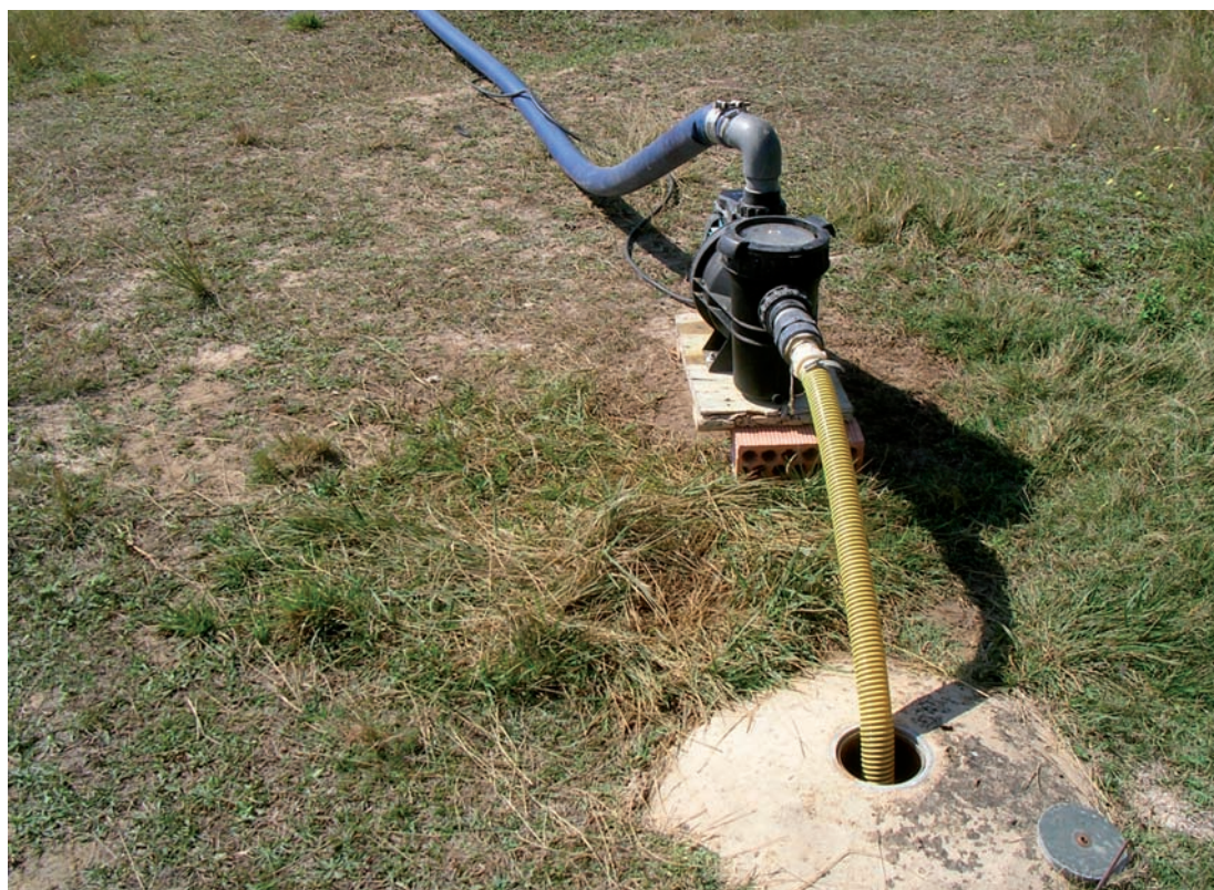
■ FIGURA 5.3.6 BOMBEO DEL PIEZÓMETRO 210870179 SITUADO AGUAS ABAJO DEL FOCO DE CONTAMINACIÓN (26/09/2013). ZONA 009-01
