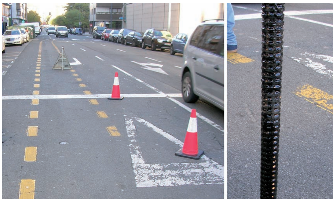
■ FIGURA 5.3.11 PIEZÓMETRO 220770184 LOCALIZADO CERCA DEL FOCO DE CONTAMINACIÓN. DETALLE DE SKIMMER TIPO OIL EATER INSTALADO EN EL PIEZÓMETRO (27/11/2013). ZONA 012-02
